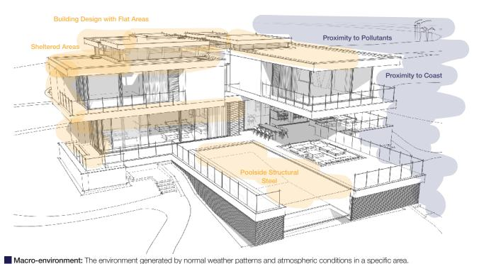
ATMOSPHERIC CORROSION: MACRO-ENVIRONMENTS VS MICRO-ENVIRONMENTS
